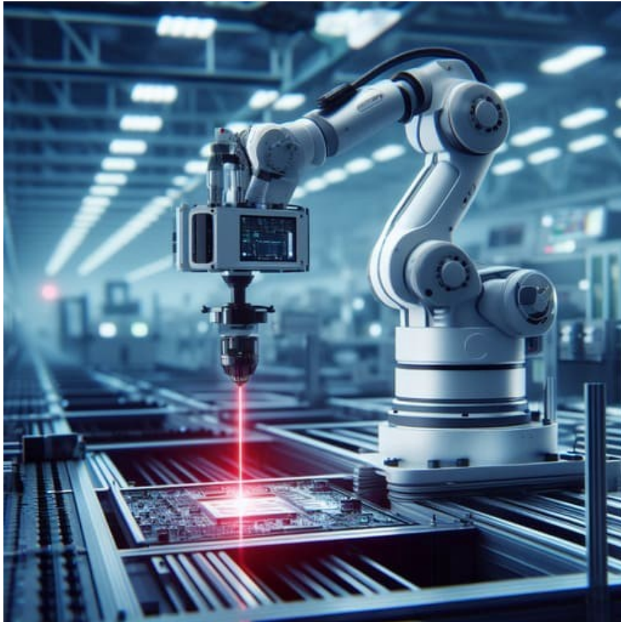
工业机器人使用 SPAD 进行飞行时间距离测量（图片来源：X-FAB）
