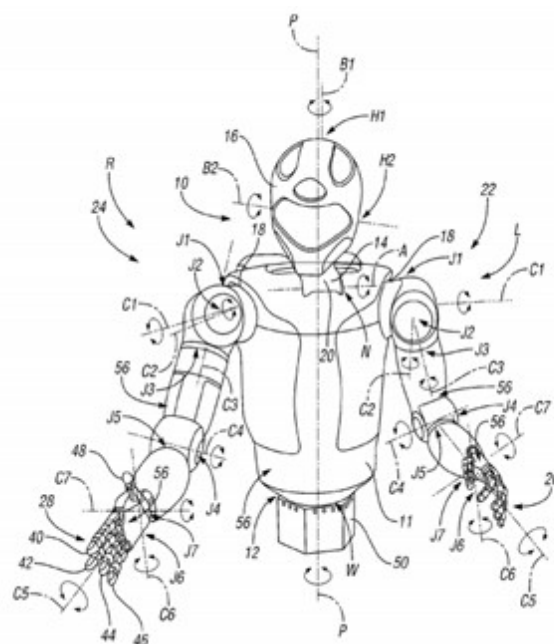
图 1 US8511964B2 公开的人形机器人的结构示意图
