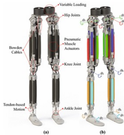
图 5 致动器在人形机器人中的分布示例
